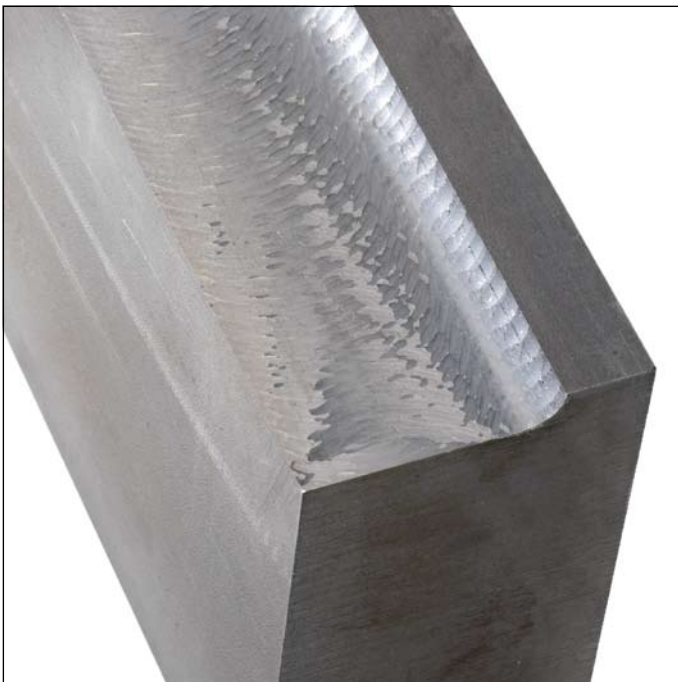
Frästeil ohne ACC bearbeitet: Deutliche Rattermarken sind sichtbar.
