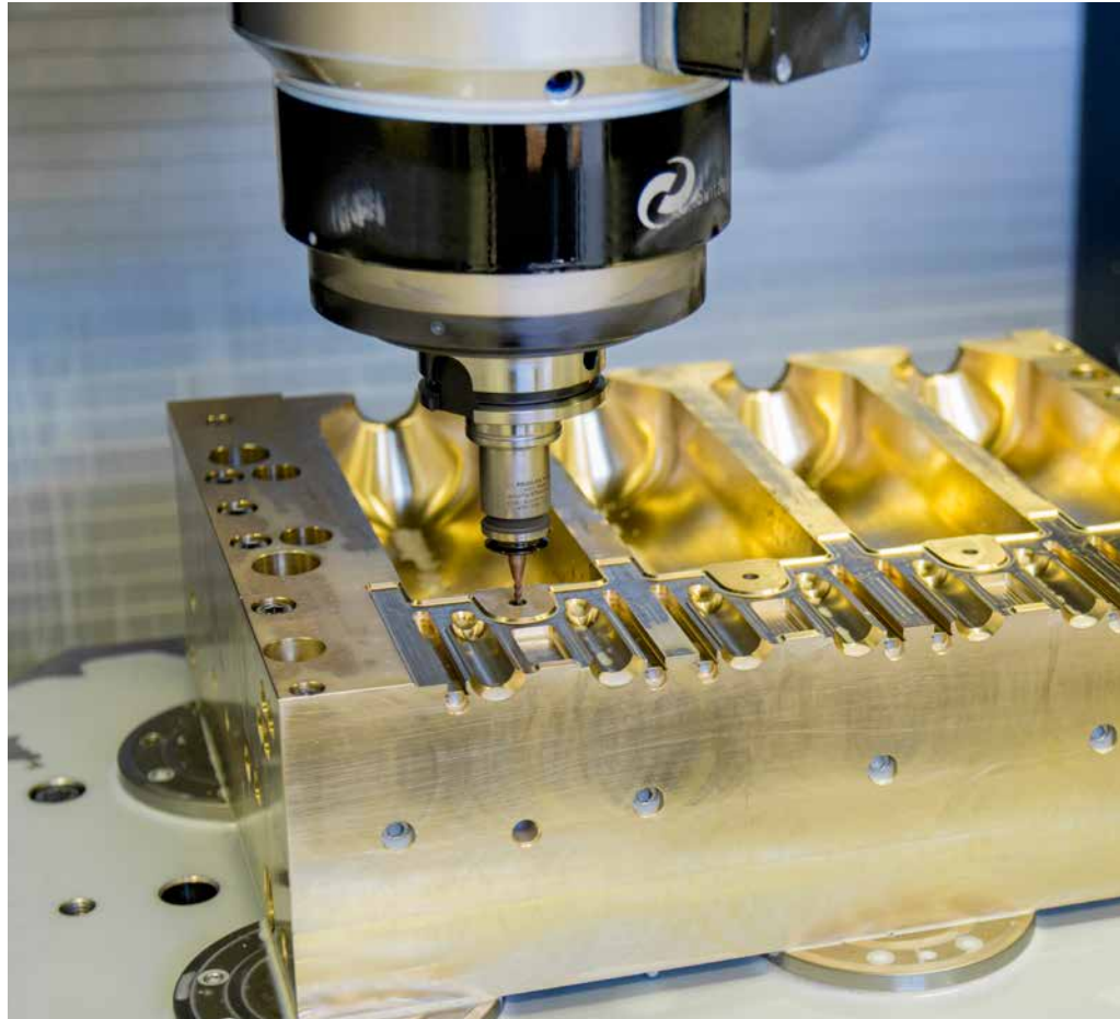
Die Bearbeitung einer Flaschenform mit Kugelfräsern nimmt viele Stunden in Anspruch – mit der iTNC 530 prozesssicher.
