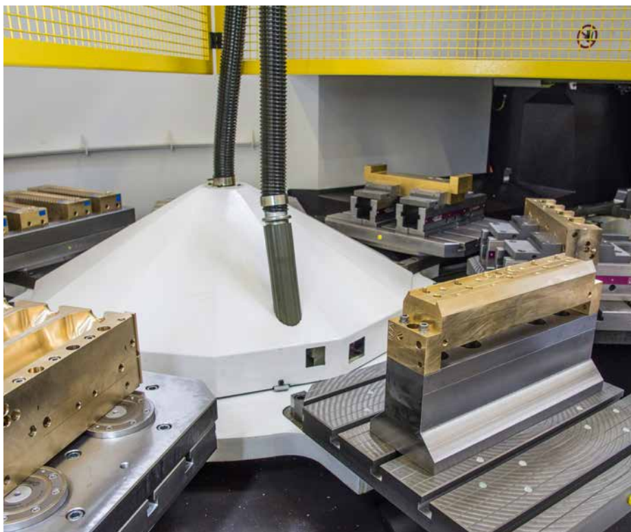
Kompakter, gut zugänglicher Palettenwechsler von GF Machining Solutions.
