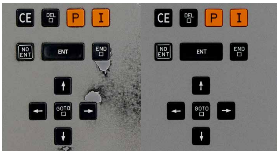
Der Kunde hat die Wahl: Funktionsreparatur (li.) oder Premiumreparatur (re.) sind technisch auf jeden Fall perfekt.
