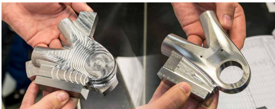
In zwei Schritten zum perfekten Teil: Gelenk für die Radaufhängung nach dem Schruppen (li.), geschliffet (re.).
