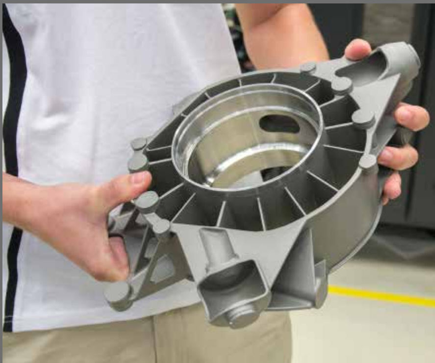
Radträger für Sportwagen: mit der HEIDENHAIN-Steuerung iTNC 530 präzise bearbeitet.
