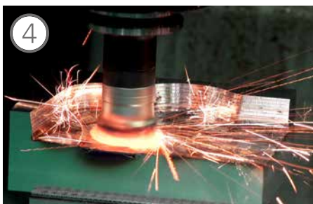
Nach weiteren 72 Minuten ohne AFC: Die Bearbeitung läuft weiter, bis Werkzeug und Werkstück glühen.
